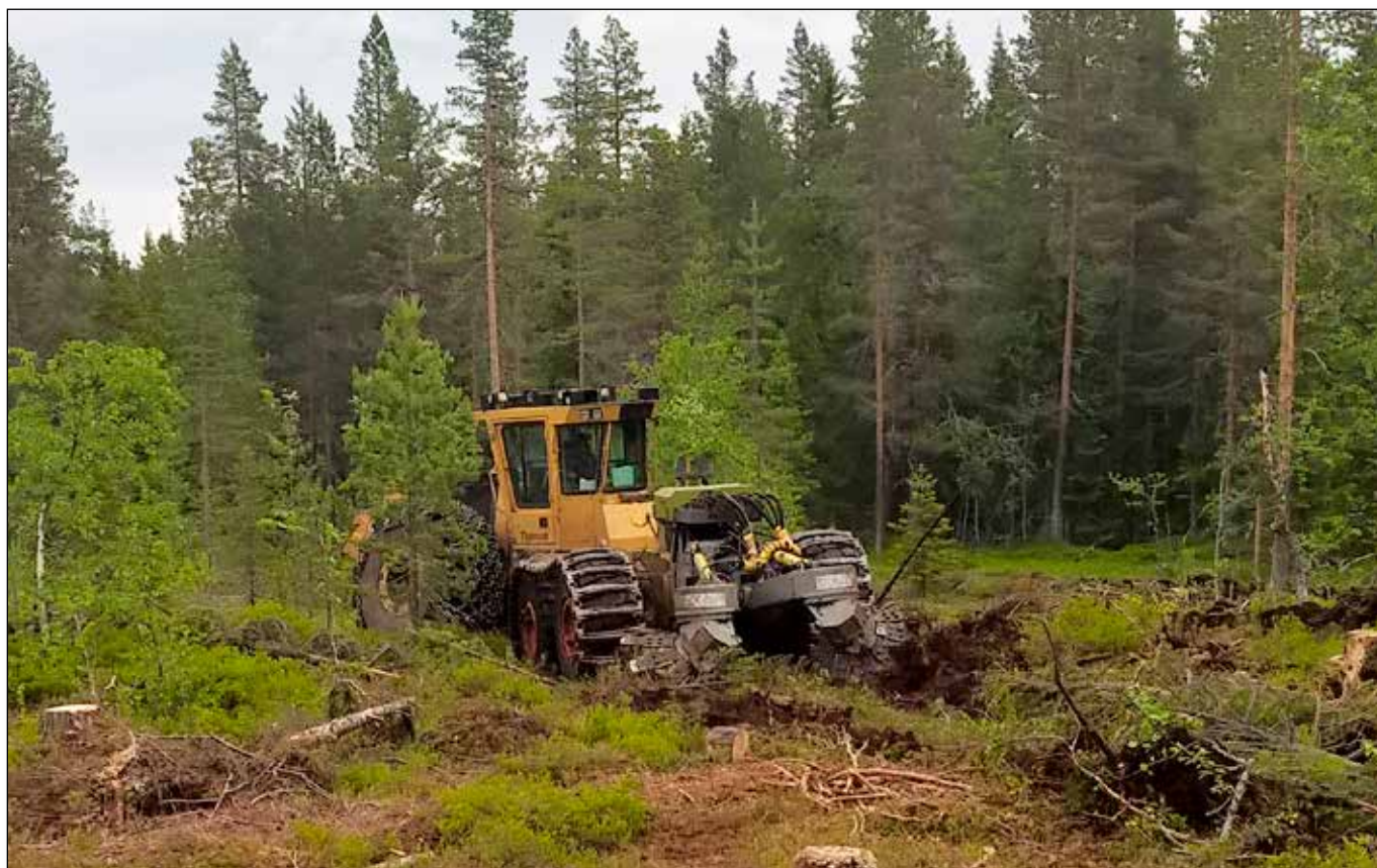
Markberedning med Tigercat påmontert såagregat.
